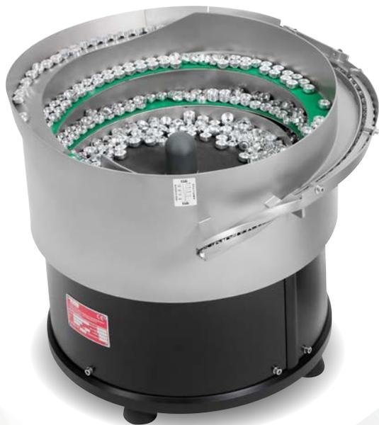
La función de este equipo es la de posicionar de un modo predeterminado las piezas que recibe a granel, transportándolas, una vez orientadas, hasta su evacuación.
