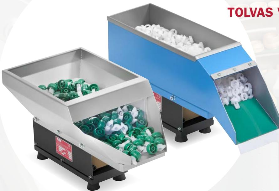
La tolva vibratoria se ubica sobre el alimentador vibratorio y su incorporación es aconsejable en muchas aplicaciones, dado que es el elemento de autonomía que permite **almacenar** las piezas a granel y dosificarlas hasta el alimentador vibratorio, asegurando además la presencia de piezas en la cuba.
